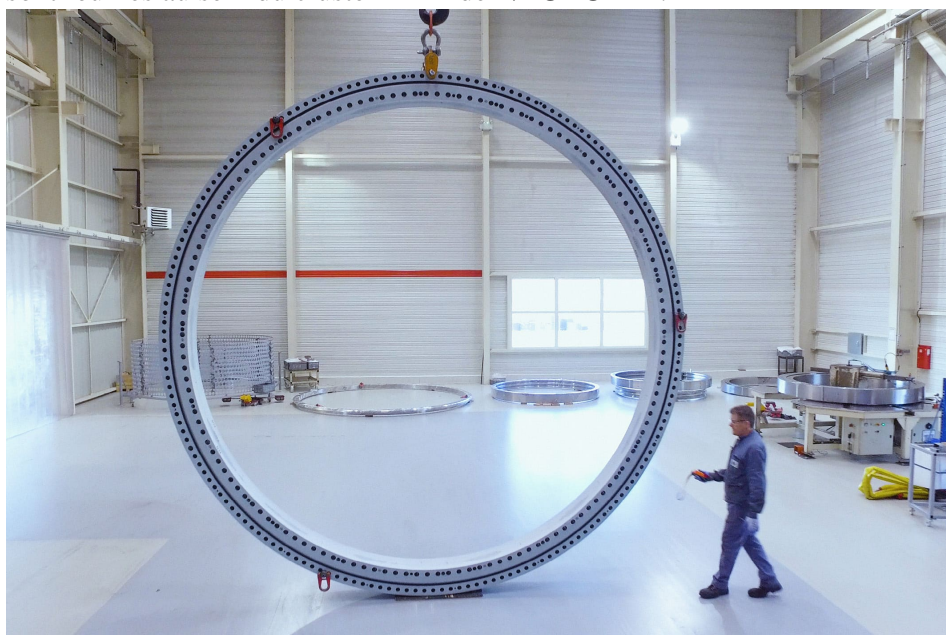
Couronne d'orientation pour éolienne réalisée par la société vendéenne Rollix Defontaine (© Rollix)
