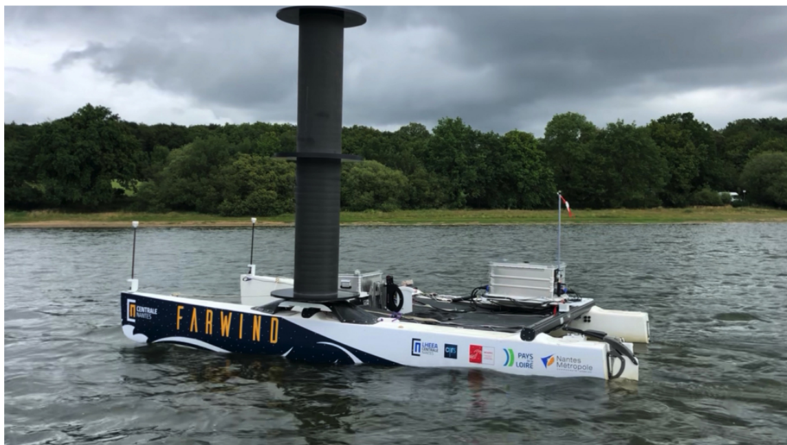
• Concept du voilier hydrolien développé par l'entreprise Farwind (© Farwind)
